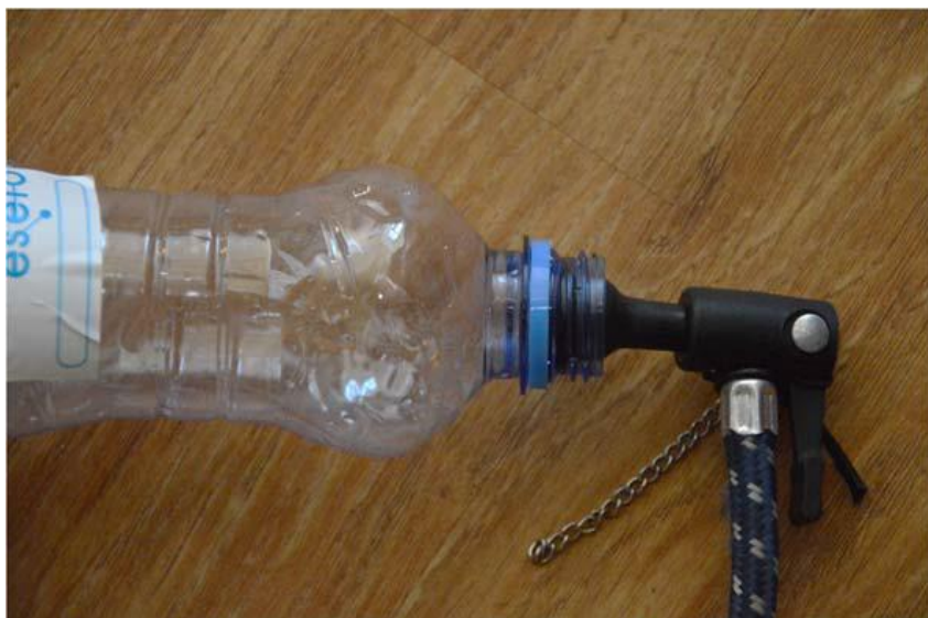
Obr. 7 Bezdušový ventilek je připojen v hrdle PET lahve (zdroj: http://fyzweb.cz/materialy/vlachovice/2015/materialy/kusak/c-kusak-rakety.pdf , cit. 15. 4. 2019)
