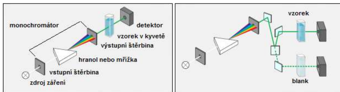
Obrázek 3 Schéma jednopaprskového (vlevo) a dvoupaprskového spektrofotometru (Evans, 2015)
