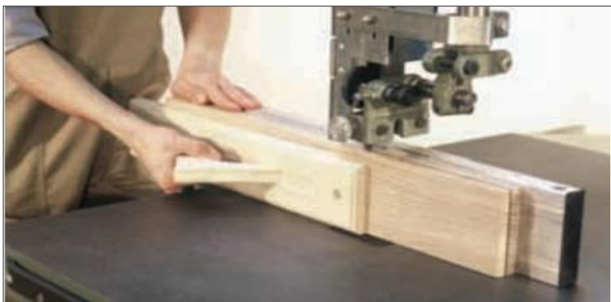
Obr. 8.4 Používání pomůcek a vodícího pravítka při řezání
