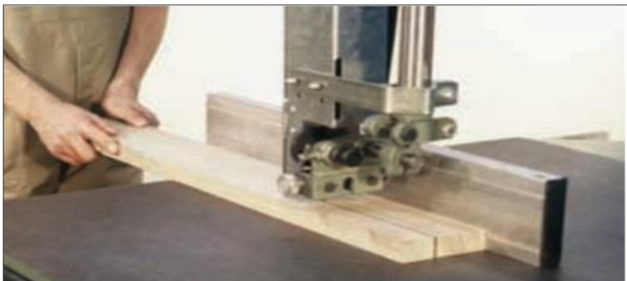
Obr. 8.5 Používání pravítka při řezání
