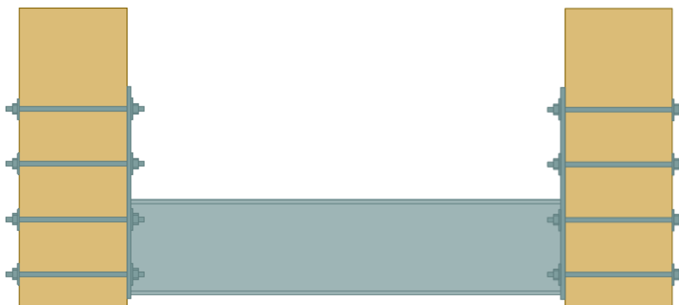
Obr. 5.1: Ocelový příčník na dřevěných nosnících
