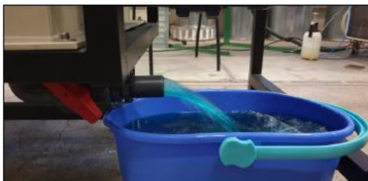
Obr. 5 Červeným kohoutem vypustíme vodu ze spodní nádrže.
