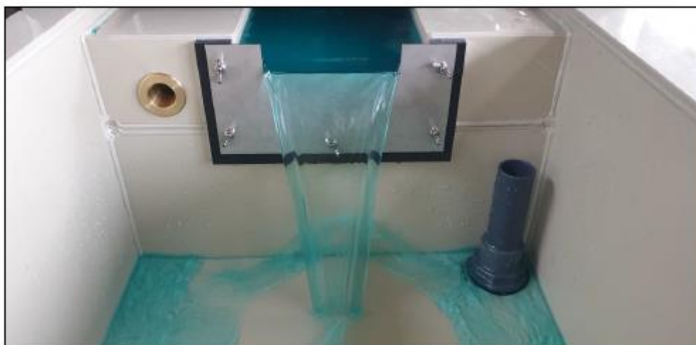
Obr. 3 Dokonalý přepad přes přeliv obdélníkového tvaru (obdélník s boční kontrakcí, Ponceletův).
