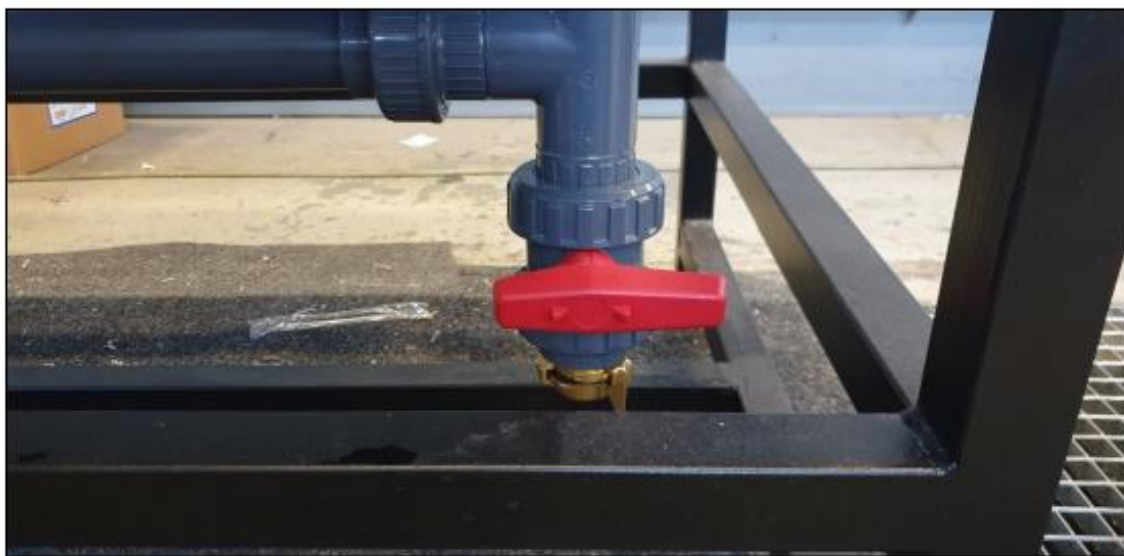
Obr. 6 Červený uzávěr výpustě pod nádobou s filtrem.
