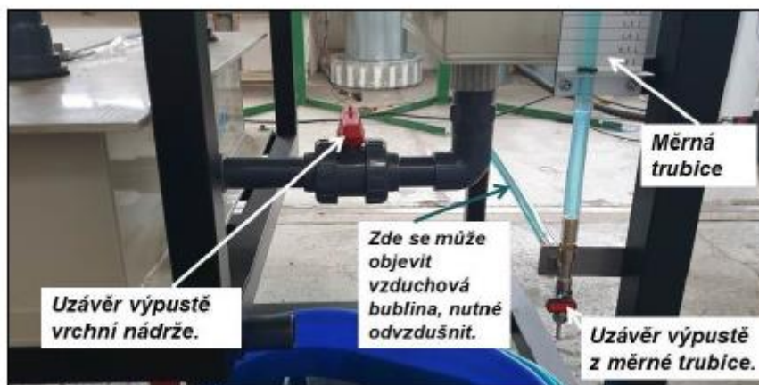
Obr. 4 Ovládací prvky nacházející se pod nejnižším bodem vrchní nádrže.
