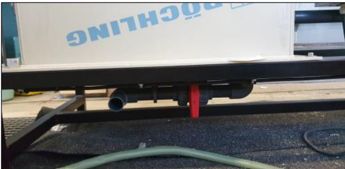
Obr. 5 Červený uzávěr výpustě pod hlavní nádrží.
