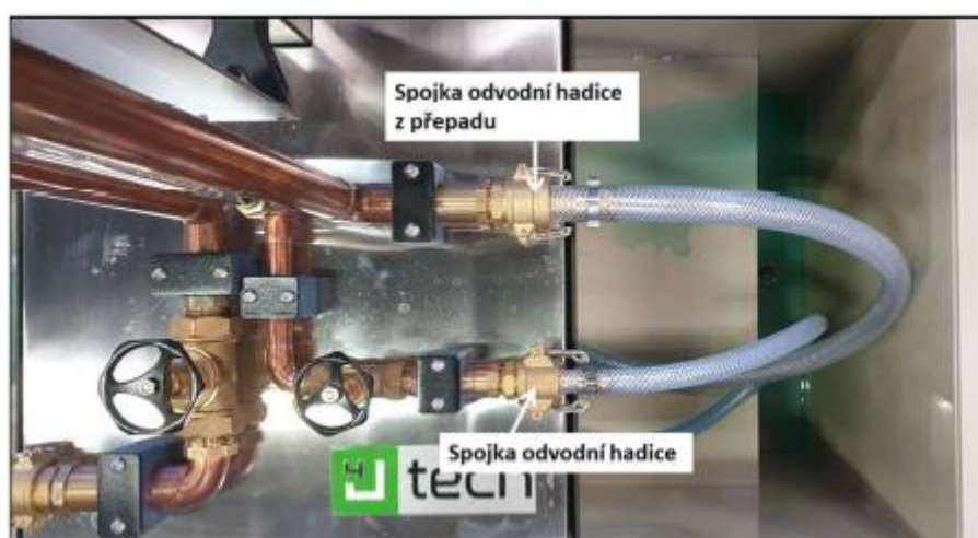
Obr. 2 Napojení odvodních hadic k Reynoldsovu modulu (pohled shora).
