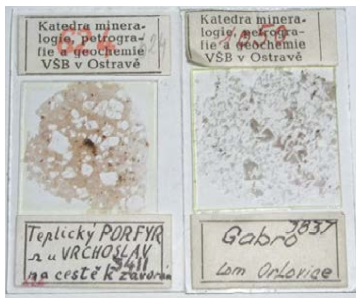
Obr. 11 Mikroskopické preparáty různých minerálů a hornin připravené k pozorování v polarizačním mikroskopu. Preparát tvoří velmi tenká destička (0.03mm) vybroušená z horniny nebo minerálu, přilepená na podložní sklíčko a překrytá krycím sklíčkem.
