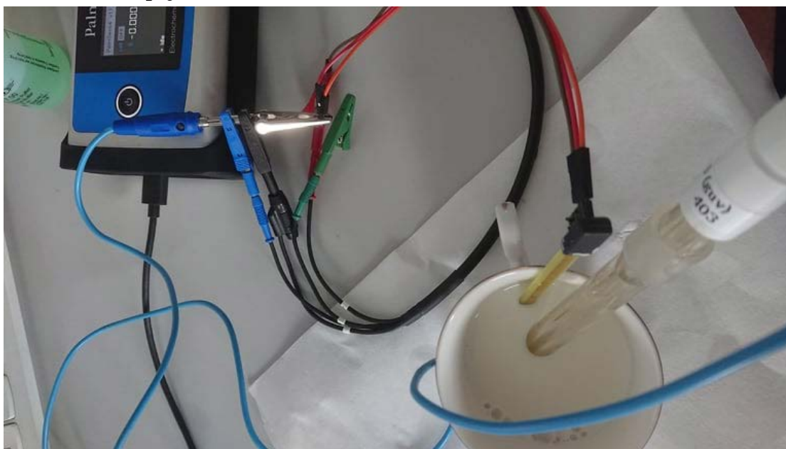
Obrázek 27: Fotografie zapojení ISFET k PalmSens 4
